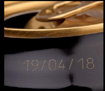
Der zweite wichtige Faktor, der die Leistungsdichte beeinflusst, ist die **Kennzeichnungsgeschwindigkeit**. Das ist die Geschwindigkeit, mit welcher der Markierkopf Zeilen mit Zeichen oder anderen Symbolen erzeugt.
